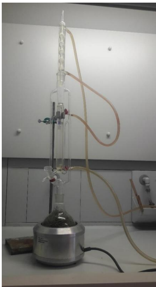
Slika 3. Clavenger aparat za vodenu destilaciju eteričnih ulja
