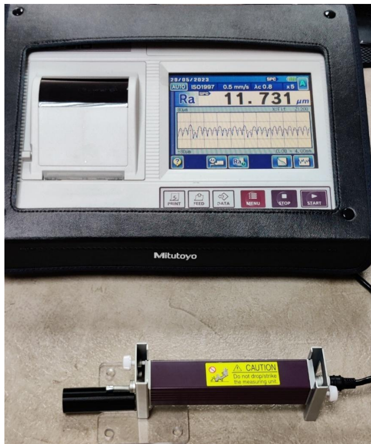
Slika 7.9 Mjerenje površine uzorka Mitutoyo Surftest SJ-310 profilometrom
