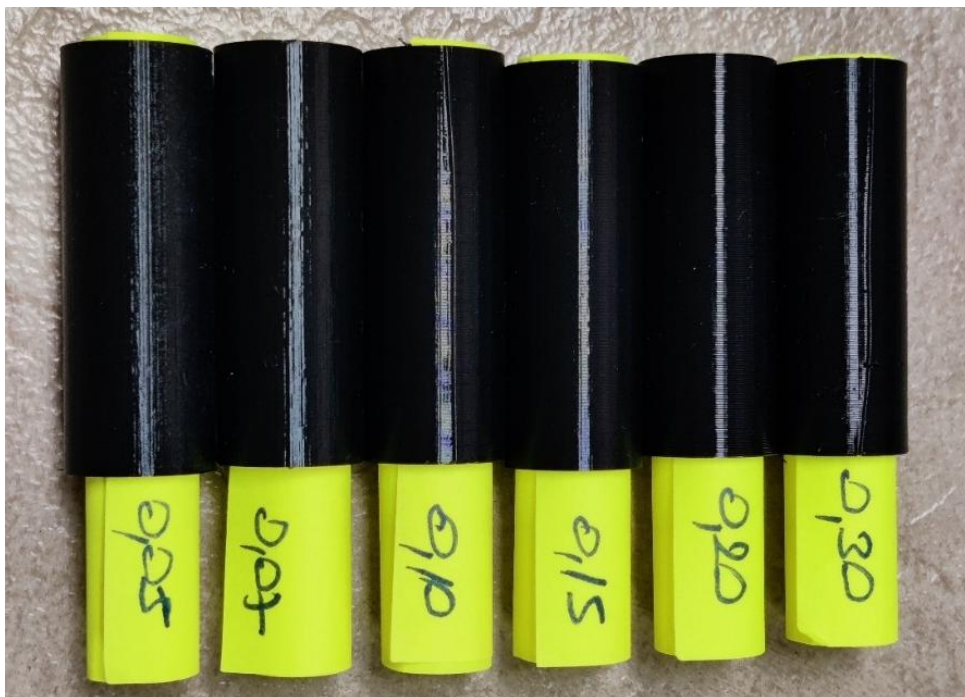
Slika 7.8 Uzorci izrađeni od TPU filamenta pri različitim rezolucijama sloja (0,05–0,30 mm)
