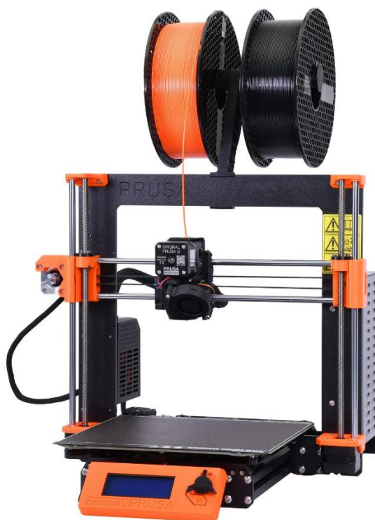
Slika 7.1 Prusa i3 MK3 – FDM 3D pisač korišten u eksperimentalnom radu [49]
