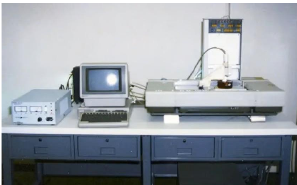
Slika 2.1 SLA-1 – prvi komercijalni SLA 3D pisač (1988.), tvrtka 3D Systems [2]
