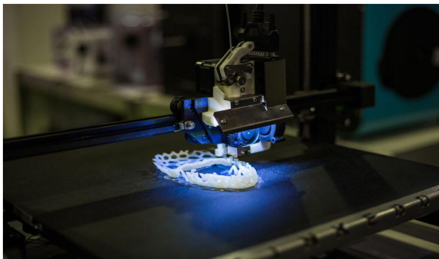
Slika 2.3 Proces 3D printanja – izrada trodimenzionalnog objekta sloj po sloj [8]
